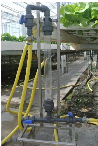
Foto 3. Biofilm device of monitoringsunit met ringen voor bepaling aangroei of accumulatie biofilm. De transparante buis wordt gedurende de gehele proef afgeschermd met zwarte plastic. Enkel bij staalname voor de ringen wordt de zwarte plastic verwijderd.
